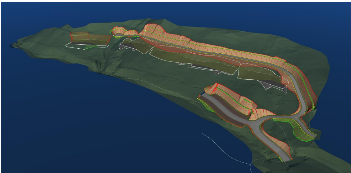
Figura 9. Proyecto 3, renderización del movimiento de tierras para el Hotel Andaz. Tomado de Civil Designer. Fuente: AECO.
