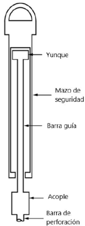
Figura 2. Martillo de percusión, SPT. Fuente: ASTM, 2018.
