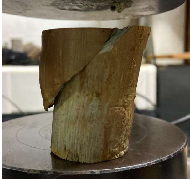
Figura 19. Muestra de suelo luego de la falla, compresión inconfiada.
