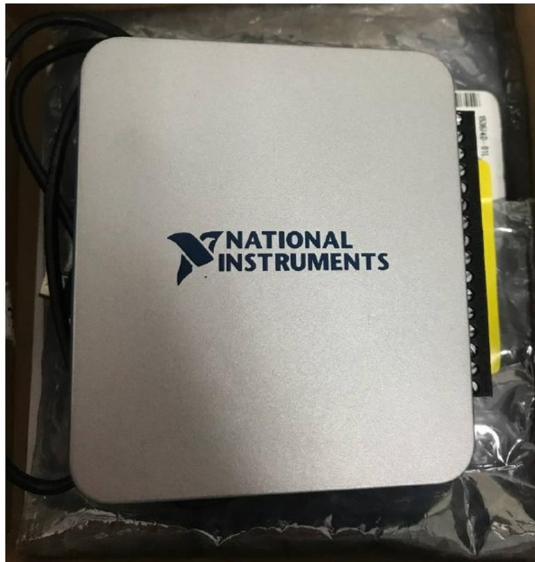
Figura 2.9: Dispositivo USB-6000. Fuente: Elaboración Propia
