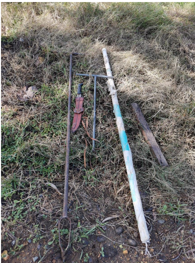
Figura 17. Parte del equipo utilizado en la elaboración de los pozos (Barrenos de 1m y 2m, Pozo de observación, machete.)
