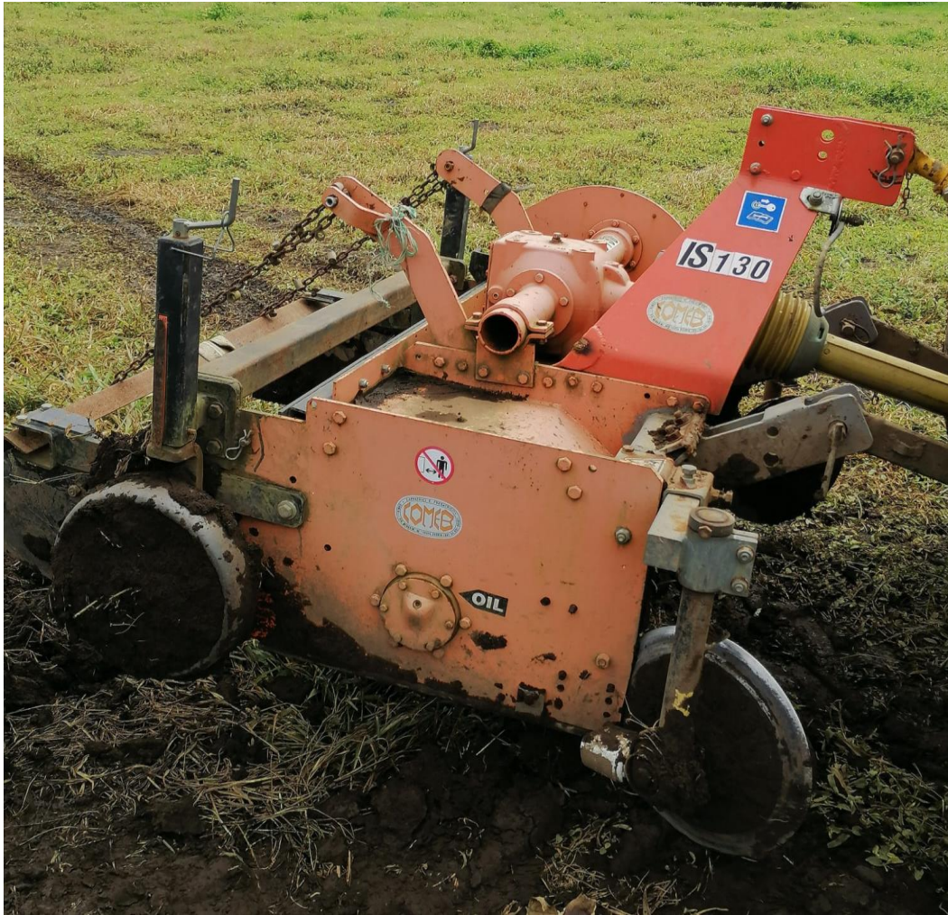
Figura 6-3 Encamador (quemador de piedra) utilizado en la preparación del terreno
