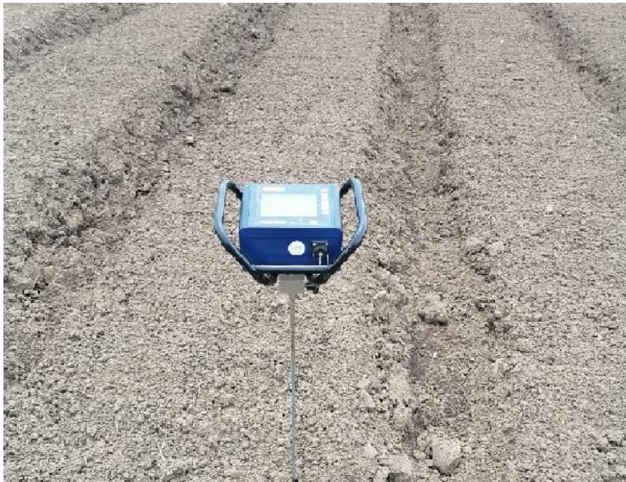
Figura 3.3-1 Utilización del Penetrologger
