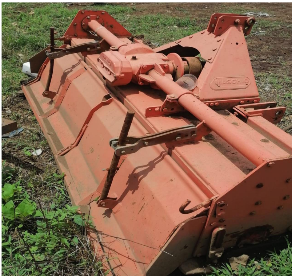
Figura 6-2 Rotador utilizado para la preparación del terreno
