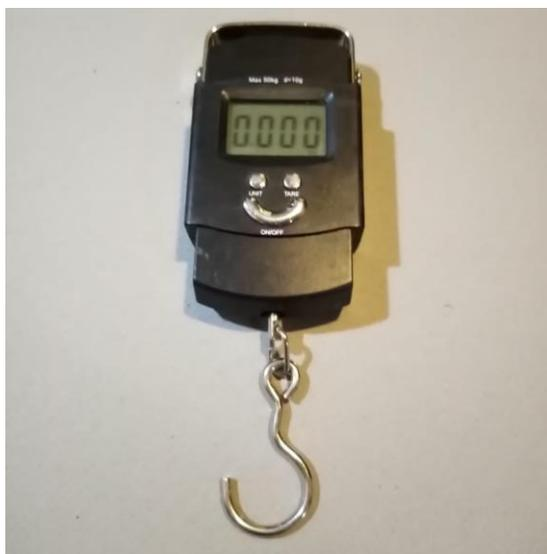
Figura 4.1. Balanza manual utilizada para pesar los residuos recolectados
