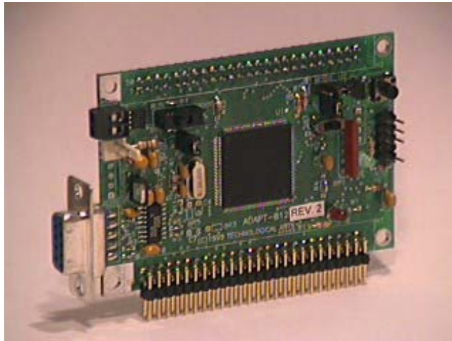
Figura 4.6: Kit de desarrollo del Microcontrolador MC68HC812A4.
