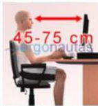
Pantalla a entre 45 y 75 cm. de distancia de los ojos y borde superior a la altura de los ojos.
