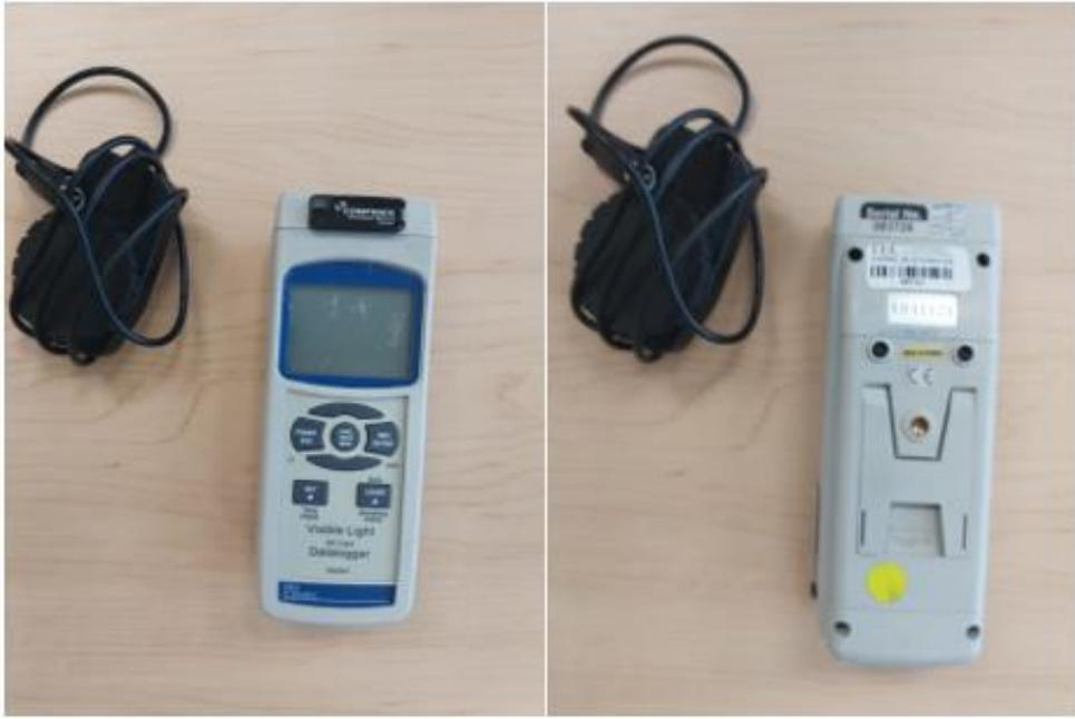
Figura 20. Luxómetro SPER CIENTIFIC con SD Card Logger 850007-SS.
