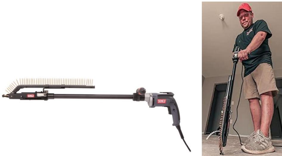
**Figura 7.** Alternativa 2 para tarea barrenado y pijado Senco 10X0003N DURASPIN.
