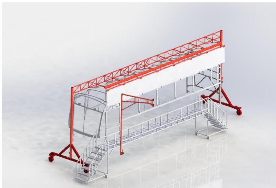
**Figura 22.** *Alternativa 3 tarea levantamiento de rollo de lámina central del toldo sistema de levantamiento para láminas estiradas*
