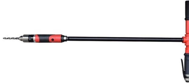
**Figura 12.** *Alternativa 2 tarea barrenado y remachado de lámina central Taladro con mango en T*
