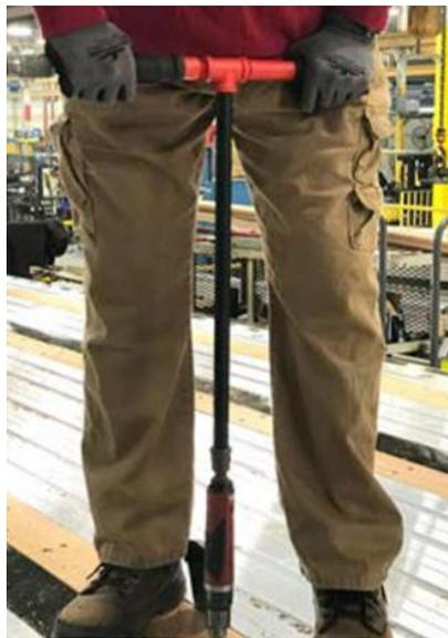
**Figura 13.** *Utilización de alternativa 2 tarea barrenado y remachado de lámina central Taladro con mango en T*
