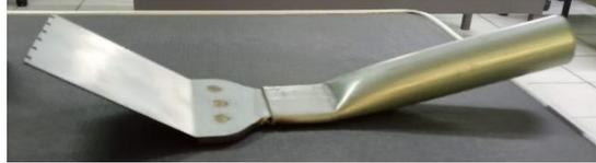
2. Una adaptación de un contenedor elaborado a partir de una lámina de aluminio para el bostik que permita que el trabajador lo rellene.
