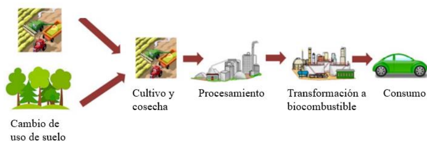
Figura 2. Proceso de producción de biocombustible. Fuente: Silalertruksa & Kawasaki (2015).
