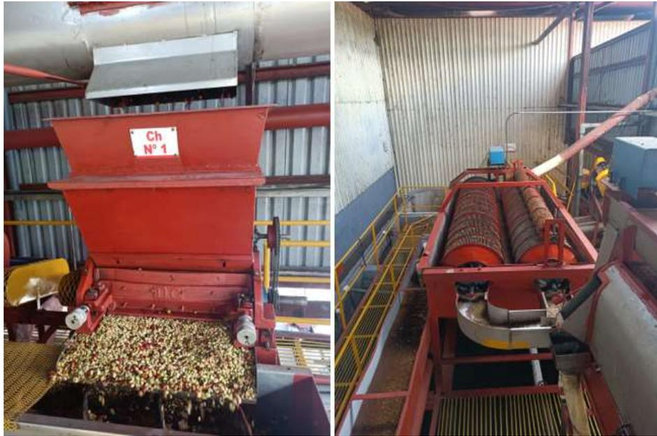
**Figura 5. Despulpado y desmucilagenado del café.**
