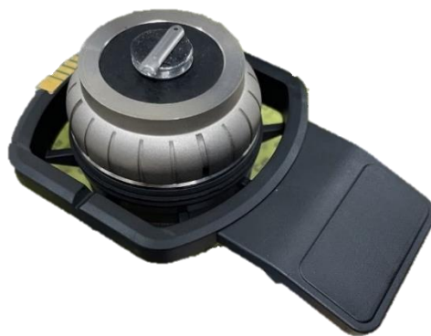
Figura 9. Colocación de muestra y porta muestras utilizado para las pruebas de SEM y EDX. Fuente: Elaboración propia.
