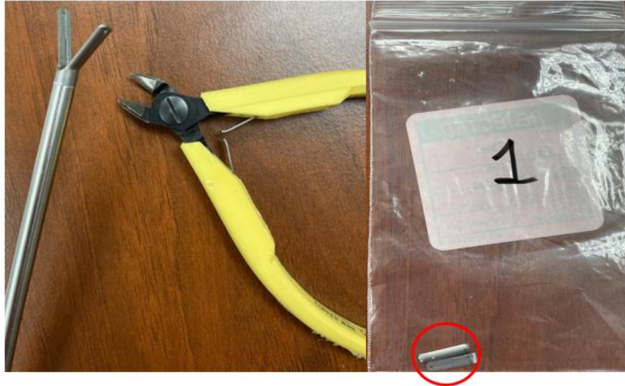
Figura 8. Corte y separación de muestras para análisis de caracterización. Fuente: Elaboración propia.
