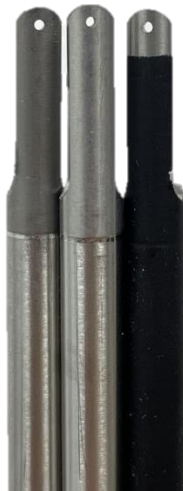
Figura 17. Comparación de tres puntas de cánula frente a diversos procesos. Cánula previa al proceso de limpieza (izquierda), cánula post proceso de limpieza (centro) y cánula pos proceso de limpieza con recubrimiento aplicado (derecha).
