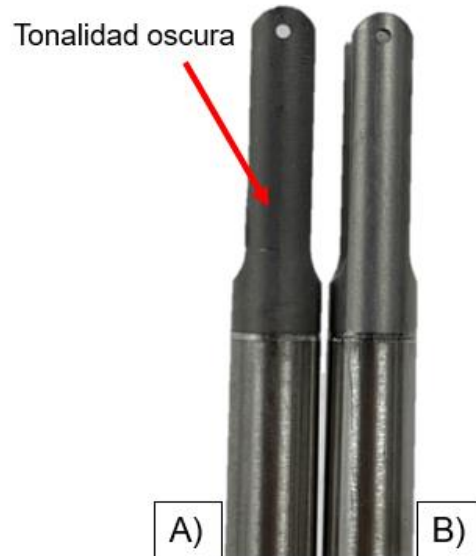
Figura 10. Muestras de la punta de la cánula donde se observa coloración gris oscura producto del contaminante presente (A). Muestra sin contaminante presente (B). Fuente: Elaboración propia.
