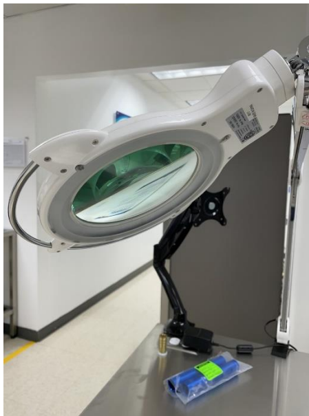
Figura 7. Lupa de apoyo en la aplicación del método de inspección visual.
