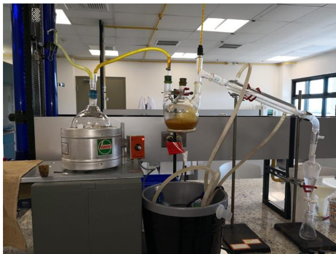
Figura 4: Equipo de destilación para extracción de aceite esencial por el método de arrastre con vapor. Fuente: Elaboración propia.
