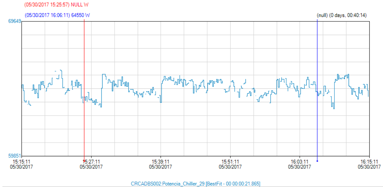
Figura 4.2: Potencia del Chiller 29 en un periodo de una hora. Fuente: Baxter productos médicos Ltda.
