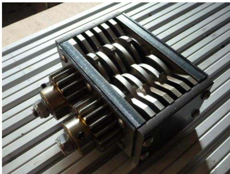
Figura 4. Diseño de un triturador personal de plásticos. Tomada de [22]
