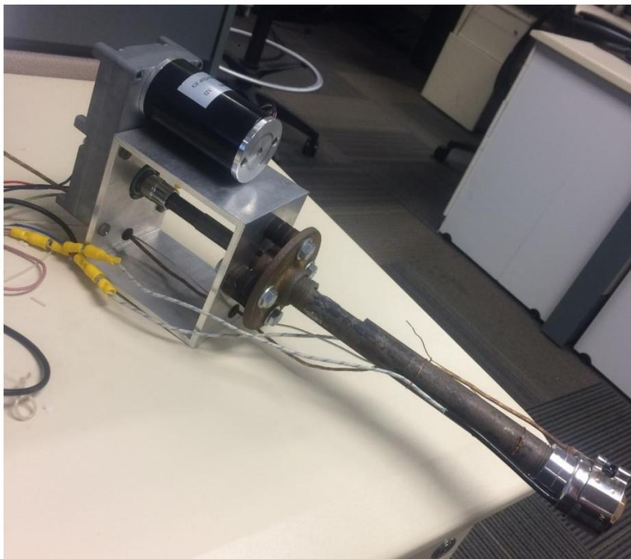
Figura 17. Sistema de reciclaje de plástico
