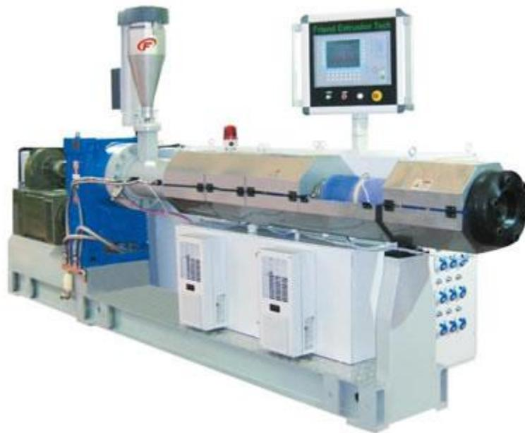
Figura 10. Extrusora de plástico industrial. Tomada de [32]
