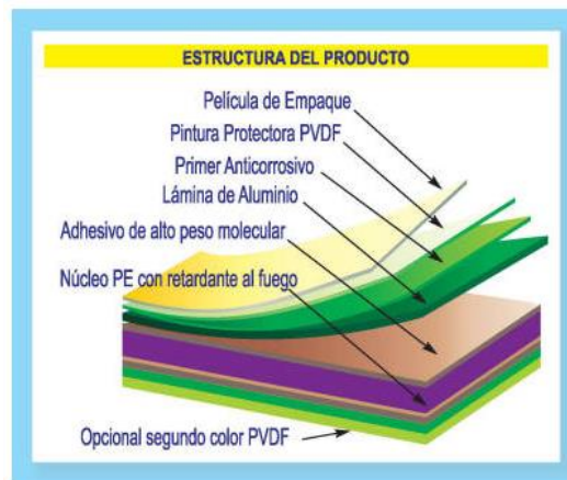
Figura 7 Estructura de la lámina de aluminio compuesto Tomado de [15]
