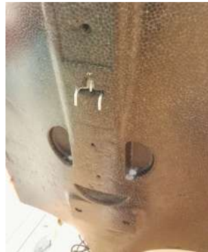
Figura 3.19: Gancho colocado en la parte inferior del UAV. Fuente: Elaboración propia.
