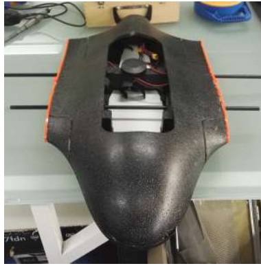
Figura 3.5: UAV con varillas y soportes de ala. Fuente: Elaboración propia.
