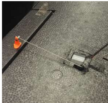
Figura 3.8: Acople mecánico entre servomotor y el alerón. Fuente: Elaboración propia.
