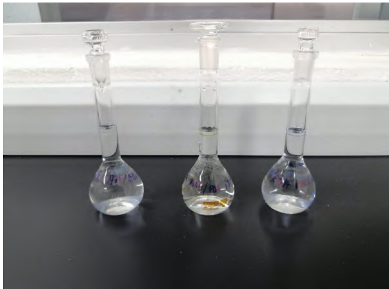
Figura A.8: Filtros de corte preparados para las pruebas de luz parásita.
