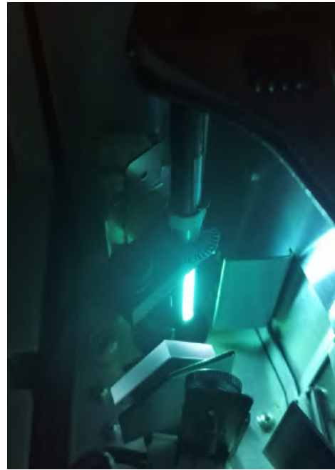
Figura A.10: Lámpara de descarga de arco de Hg tipo lápiz, utilizada para la prueba de verificación del ABE y la calibración primaria del EFAR.
