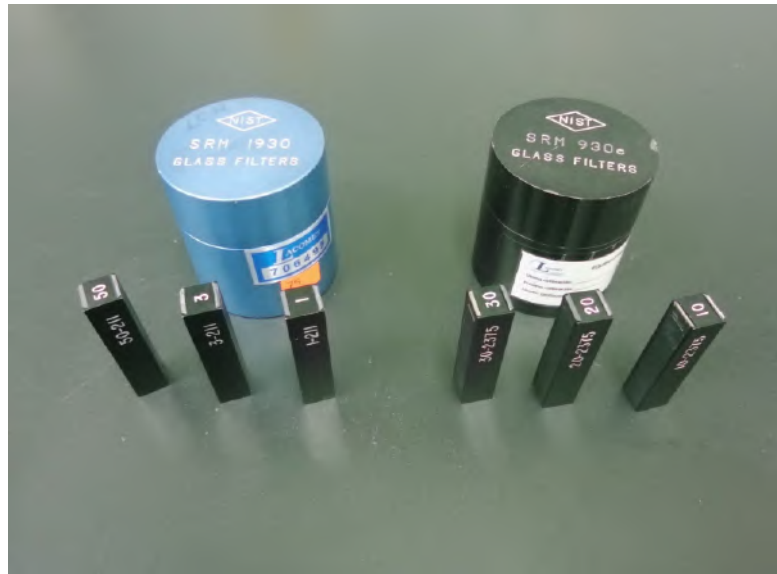
Figura A.7: Filtros de densidad neutra utilizados en las pruebas de caracterización del EFAR.
