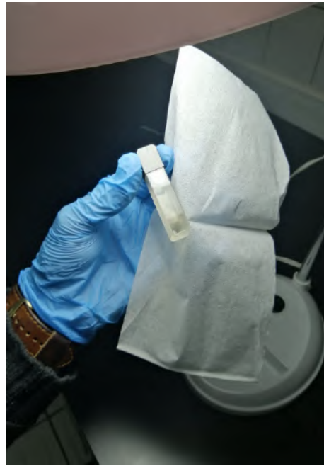
Figura A.12: Limpieza del filtro SRM 2034 antes de las mediciones con el EFAR.
