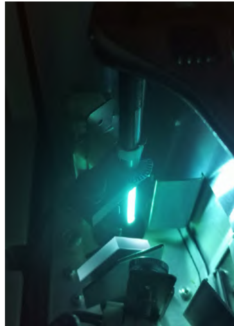
Figura A.11: Funcionamiento de la escala graduada para el proceso de alineamiento. La escala roja es la escala útil y define las rotaciones angulares a cuantificar.
