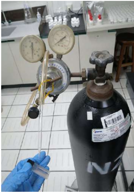
Figura A.12: Limpieza del filtro SRM 2034 antes de las mediciones con el EFAR.
