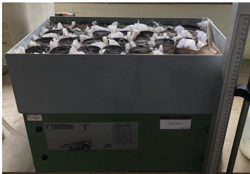
Figura 5. Anillos con muestras de suelo en el equipo caja de arena.
