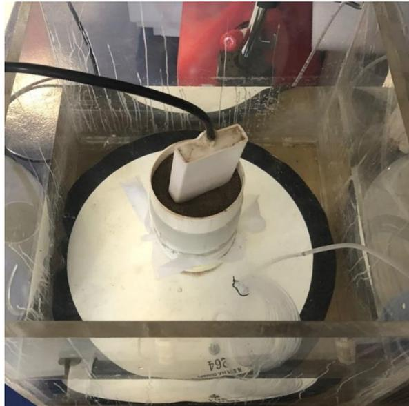
Figura 8. Determinación punto de saturación para el modelo de calibración de los sensores de humedad.
