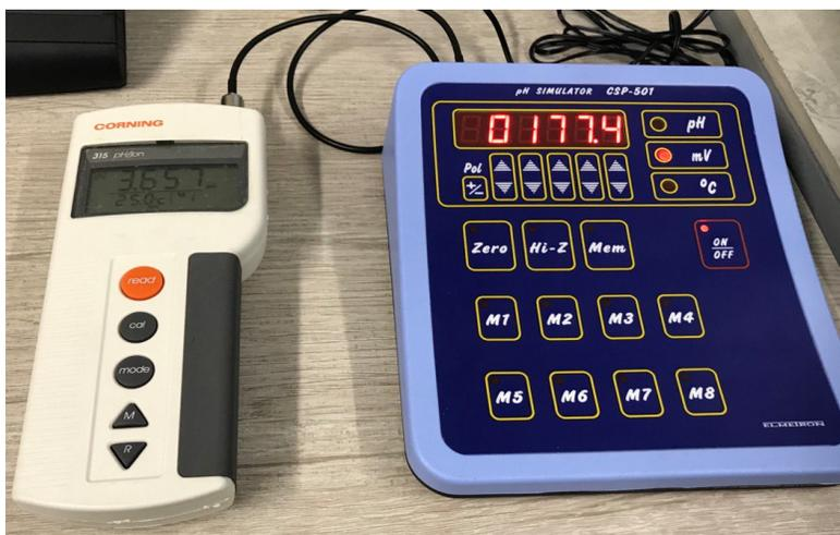
Figura 5: Medición de pH 4 con el simulador de pH haciendo la corrección debido a la tensión del punto isoelectrico.
