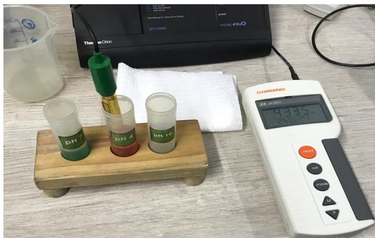
Figura 3: Medición de pH 4 antes del ajuste del medidor de pH.
