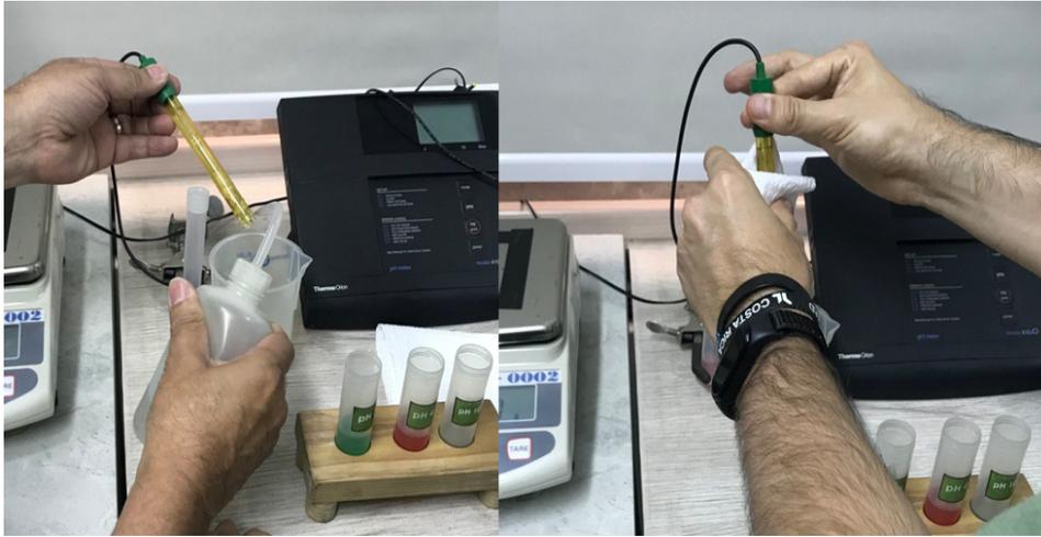
Figura 2: Limpieza y secado del electrodo del medidor de pH.
