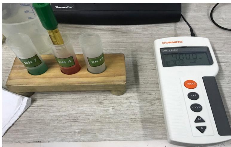
Figura 4: Medición de pH 4 después del ajuste del medidor de pH.
