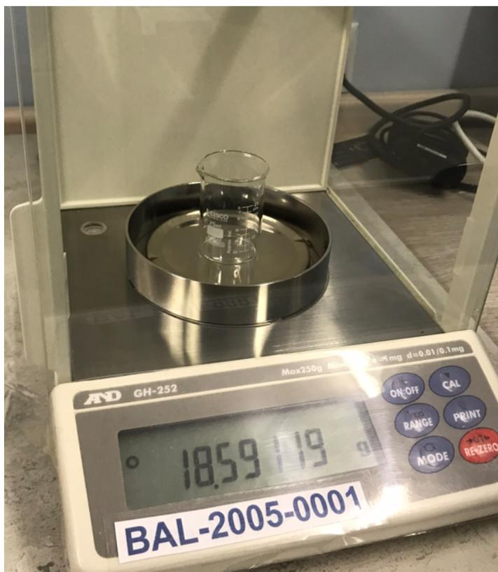
Figura 15: Pesaje del recipiente auxiliar vacío.
