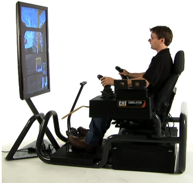
Figura 13: Cabina de Simulación de la CAT. Extraída de CATSimulators (2012).
