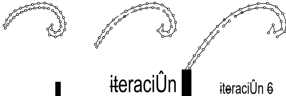
Figura 3.25: Ejemplo del metodo forrajeo (parte II) para el crecimiento de la silueta del fragmento de la cabeza del nematodo usando u^0 = 5 y s = 1:3 en cada iteracion.
