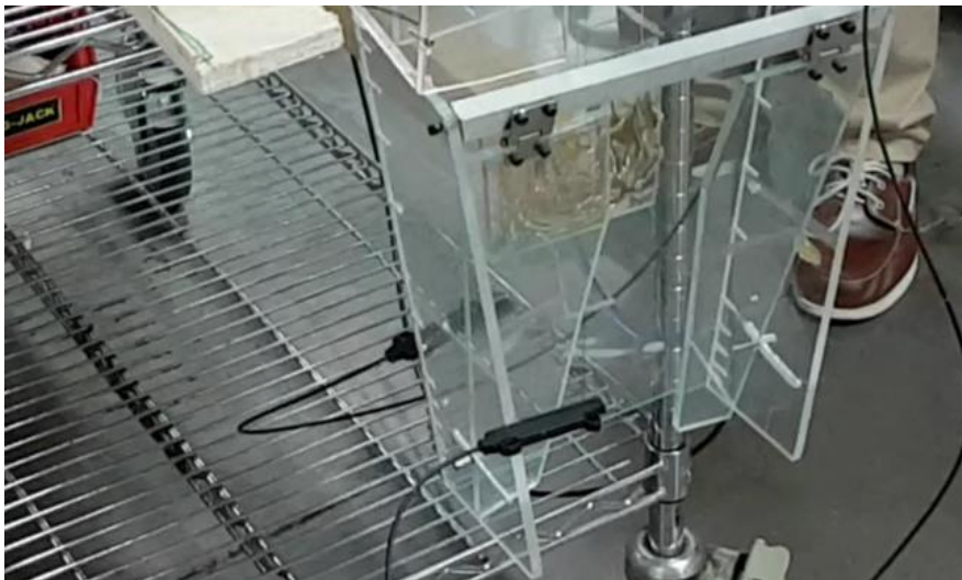
Fig. 32 Fotografía detallada del sensor inferior del sistema
