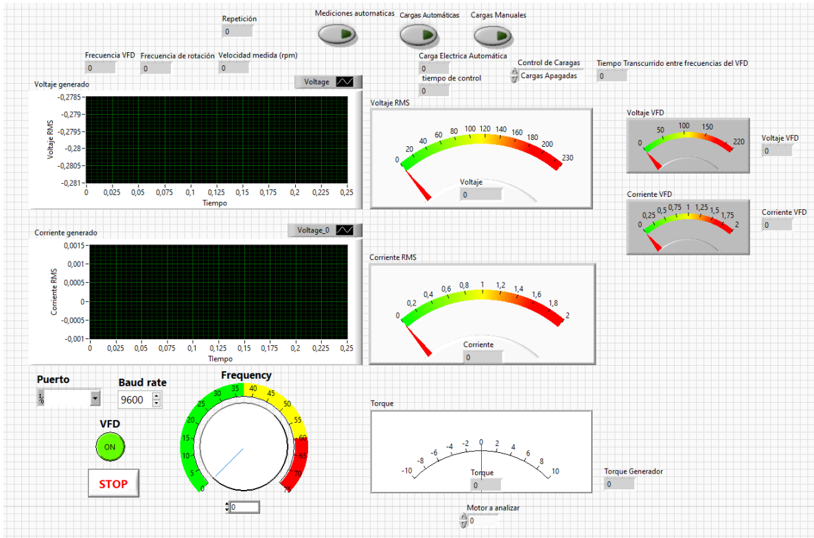
Figura I.2: Interfaz gráfica desarrollada para la recolección de datos y la monitorización en tiempo real de variables de interés como velocidad, corriente, voltaje y torque, así como el control de las cargas y la comunicación con el VFD mediante el protocolo modbus
