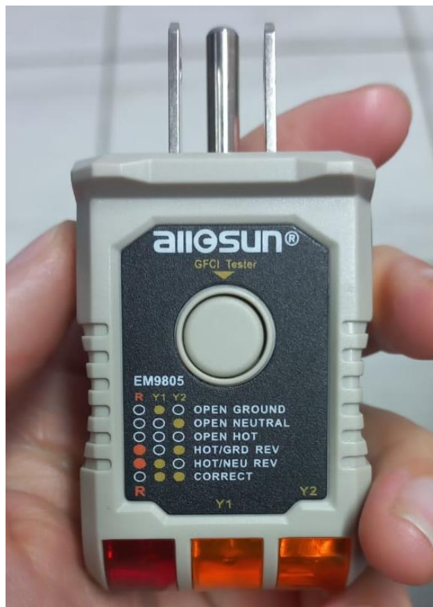
Figura 7: Probador de salida GFCI [Elaboración propia].
