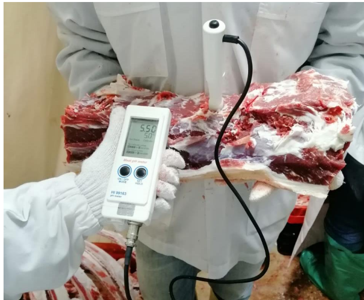
Figura 14. Medición del pH y temperatura en el músculo Longissimus dorsi con el pH-metro marca Hanna Instruments modelo HI 99163.
