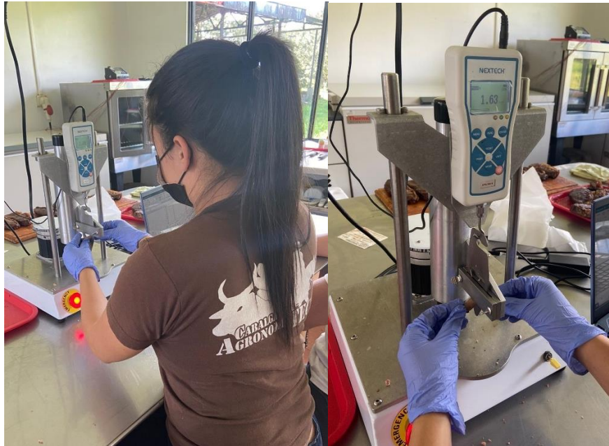
Figura 21. Medición de la fuerza de corte con el equipo Warner-Bratzler Shear Machine.
