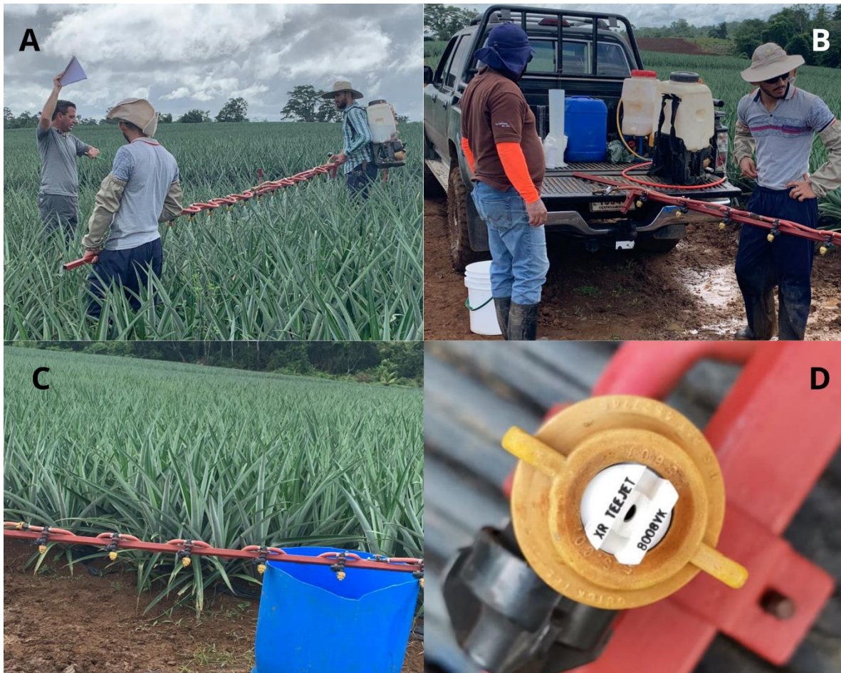
Figura 6. Proceso de calibración del equipo previo a la aplicación de los tratamientos (A). Motobomba Husqvarna 325S25 y otros insumos requeridos para realizar la respectiva preparación de las disoluciones y aplicación de los tratamientos (B). Brazo de aplicación de 5 metros utilizado para la aplicación de cada una de las parcelas (C). Boquilla XR TEEJET 8008VK utilizadas para la aplicación de los tratamientos (D).
