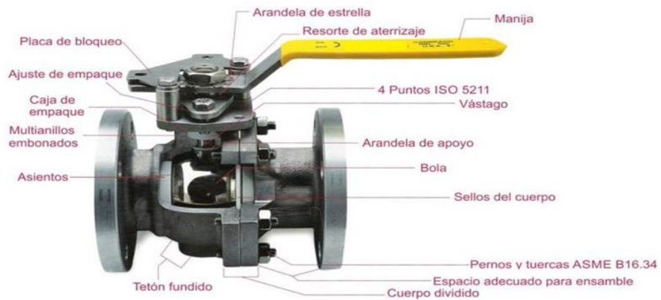
Figura 8. Diagrama de una válvula de bola. (Fuente: GRUPO HIDRAULICA, 2022)
