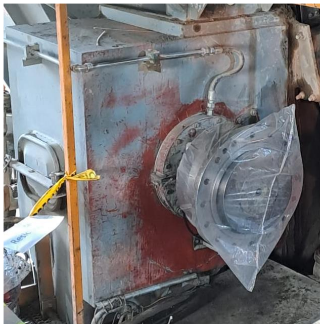
Figura 8. Encerramiento del piñón-corona
