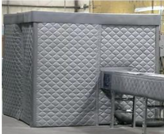
Figura 13. Cabina acústica Molino Horomill
