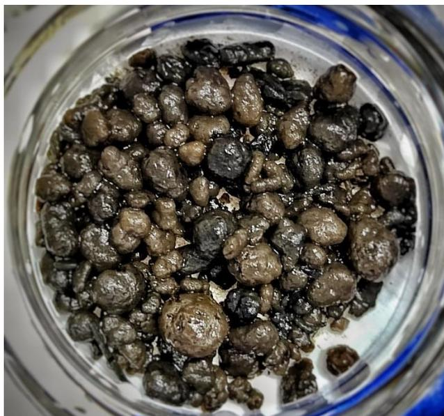
**Figura 3.2. Lodo aerobio granular utilizado en el experimento**
