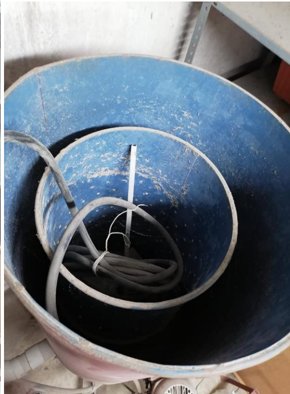
Figura 0.19. Tambor interno y externo de la centrifuga modelo.
