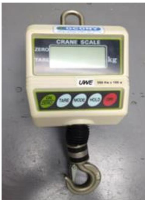
**Figura 5.2. Báscula utilizada en Análisis de Composición.**
