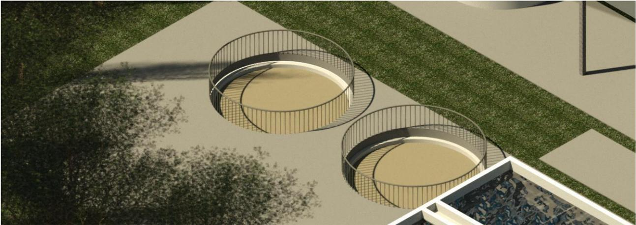
**Figura Ap.3.5. Detalle de los lechos de secado.**
