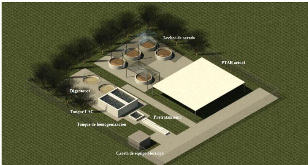
**Figura 1.12.12. Vista superior lateral del modelo tridimensional de la PTAR.**
