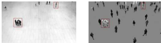
Figura 6: Objetos con poco movimiento en \mathcal{V} que quedan como parte del fondo al aplicar GoDec .
