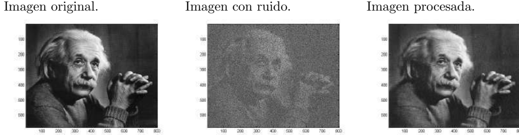
Figura 3: Ejemplo de aplicación de la pseudoinversa en procesamiento de imágenes.
