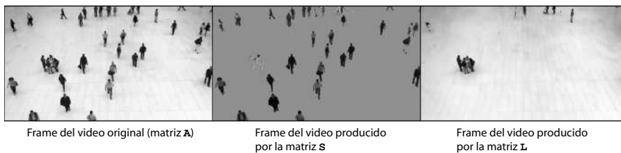
Figura 5.1: Muestra del mismo frame, tanto del video original, como de los videos generados con las matrices S y L .
