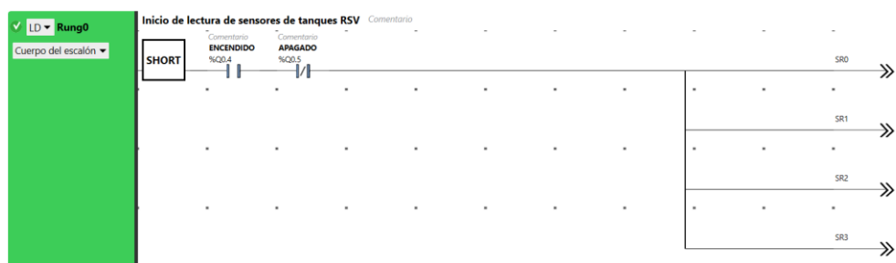
Figura 25. Programación del nivel de llenado del tanque 1 del reservorio
