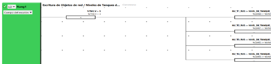
Figura 26. Programación de variables de red, nivel de los tanques del reservorio
