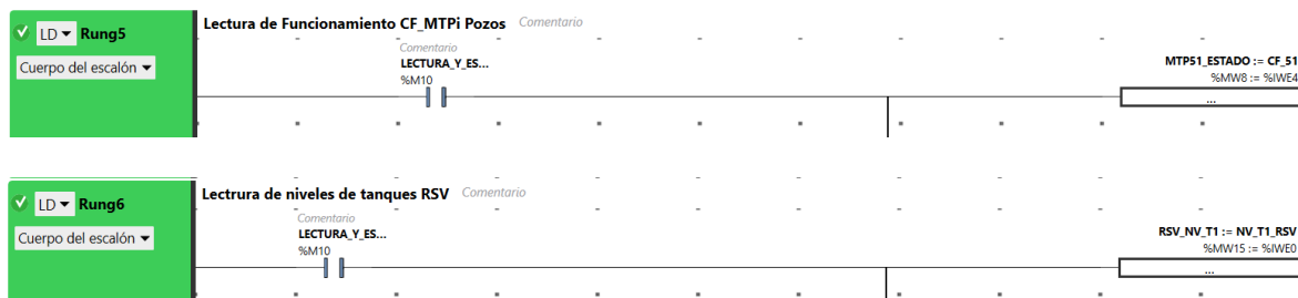
Figura 13. Lectura de los objetos de red, niveles de los tanques del reservorio
