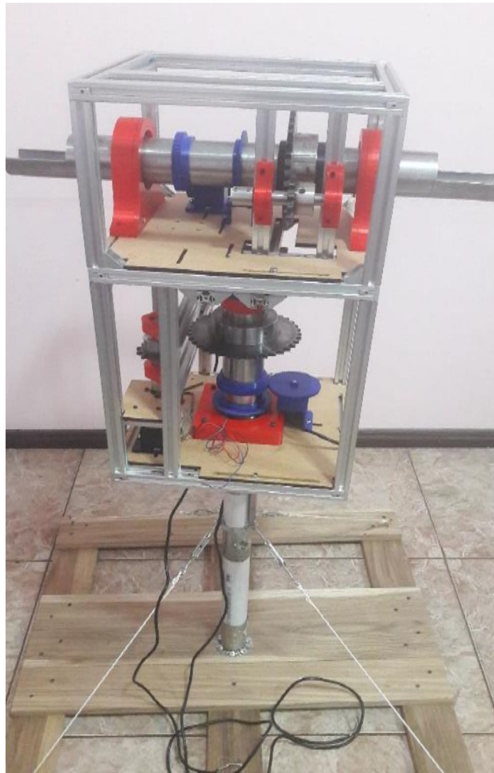
Figura 31. Prototipo del sistema de seguimiento de satélites para las operaciones de GWSat. [27]
