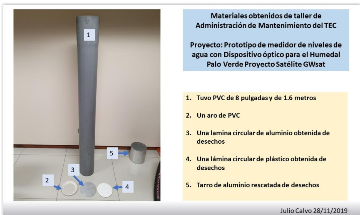
Figura 6. Componentes para implementación del prototipo del dispositivo de medición de nivel de agua y variables ambientales para el humedal fuentes: Dr. Julio Calvo Alvarado.
