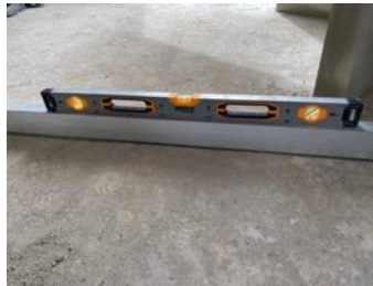
Figura 47. Revisión del procedimiento de medición de la horizontalidad utilizando el método 1.
