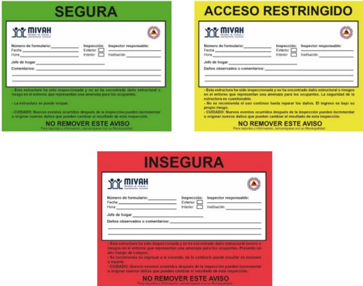
Imagen 18. Etiquetas informativas sobre el grado de daño en viviendas.
