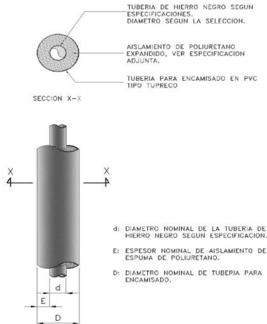
DIAGRAMA ESQUEMATICO TUBERIA TUPRECO SIN ESCALA
