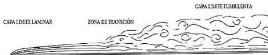
Figura 5 Capa límite laminar y turbulenta. Fuente: (González & Castellano, 2014)
