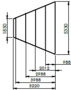
Figura 11 Dimensiones para corte de angular. Fuente: Generación propia SolidWorks ( 2018).
