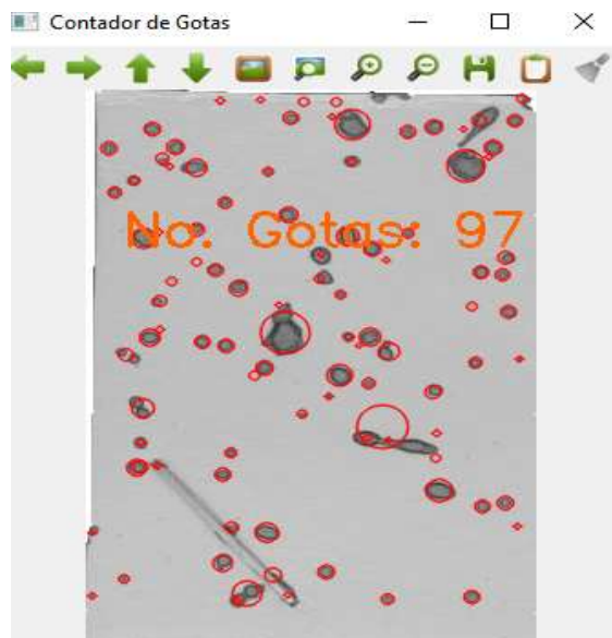
Figura 8. Conteo de gotas con el programa Spyder en la aplicación con bomba.
