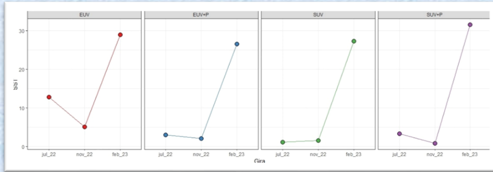
Figura 27: Detalle del comportamiento de los SST (ECMAR) entre las diferentes etapas de depuración.
