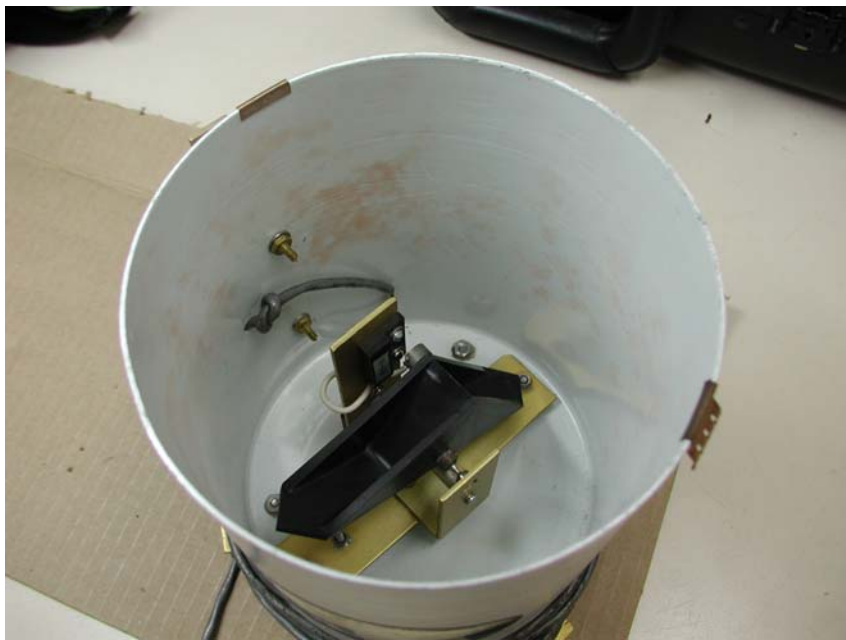
Figura 4.5 Vista superior del medidor pluvial
