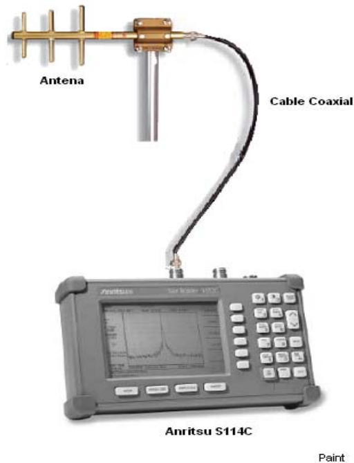
Figura 5.4 Circuito de medición de la potencia y frecuencia de recepción
