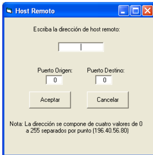
Figura A.7 Ventana para introducir la dirección IP remota y los puertos del módulo.
