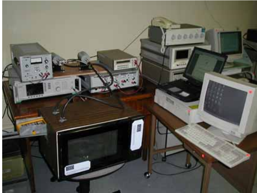
Figura 6.6 Imagen de la conexión de todas las partes que conforman el sistema diseñado para la elaboración de los reportes de calibración del medidor de campo EMR-300.
