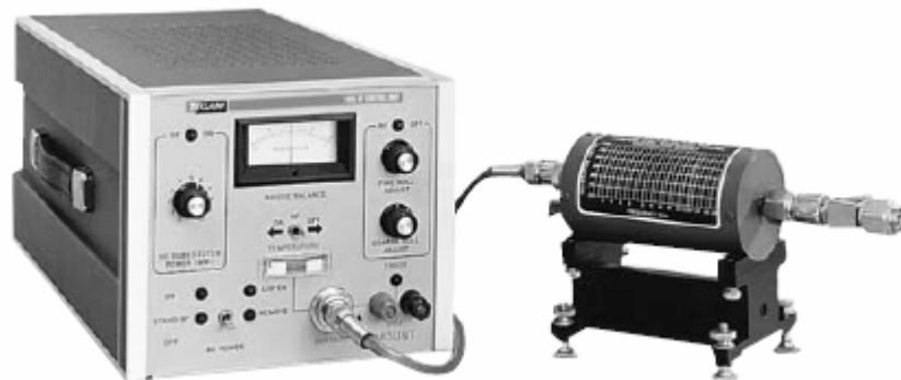
Figura 4.3 Unidad de control de potencia acoplado con el termistor F1109 que brindan la potencia transmitida.
