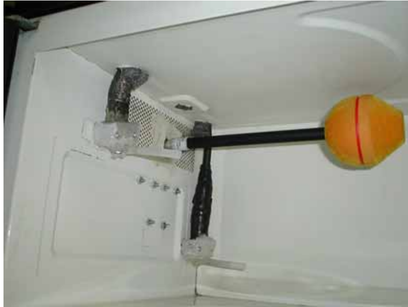
Figura 6.4 Imagen de la posición en la cámara aislada de la antena transmisora y receptora, así como de la sonda del medidor de campo EMR-300.
