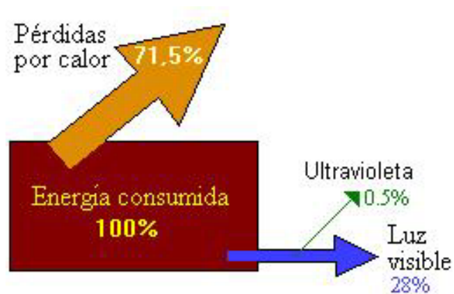
Figura 3.11 Balance energético de una lámpara de vapor de sodio a alta presión [8]
