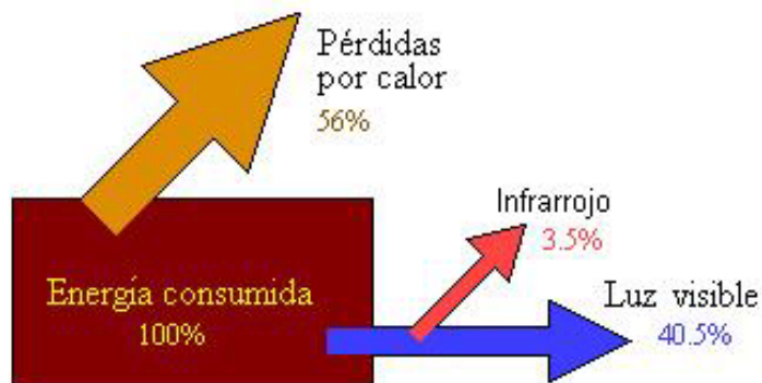
Figura 3.13 Balance energético de una lámpara de vapor de sodio a alta presión [8]
