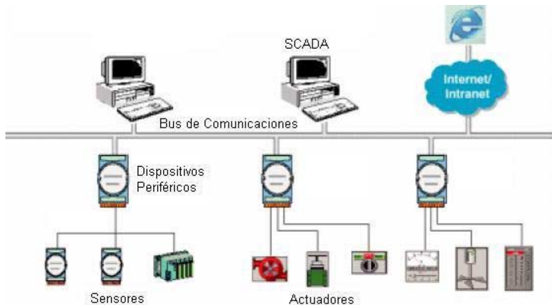
Figura 3.7 Diagrama de sistema de monitoreo y control [2]
