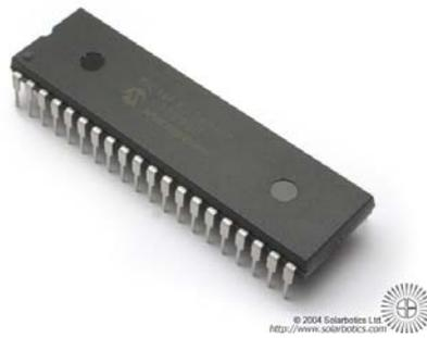
**Figura 5.2.1** Microcontrolador PIC16F877A
