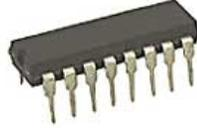
**Figura 5.2.18** Convertidor digital analógico MC1408-8
