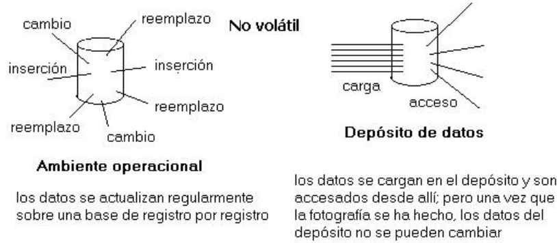
Figura 9. Contraste de la característica de no volátil entre el ambiente operacional y el ambiente de depósito de datos.
